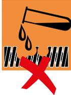
**IT** Evitare di stoccare le molle in posizione completamente compressa per lunghi periodi. Proteggere le molle da agenti corrosivi per evitare ossidazioni e prematuri cedimenti. Sostituire sempre le molle che presentano segni di ossidazione.
